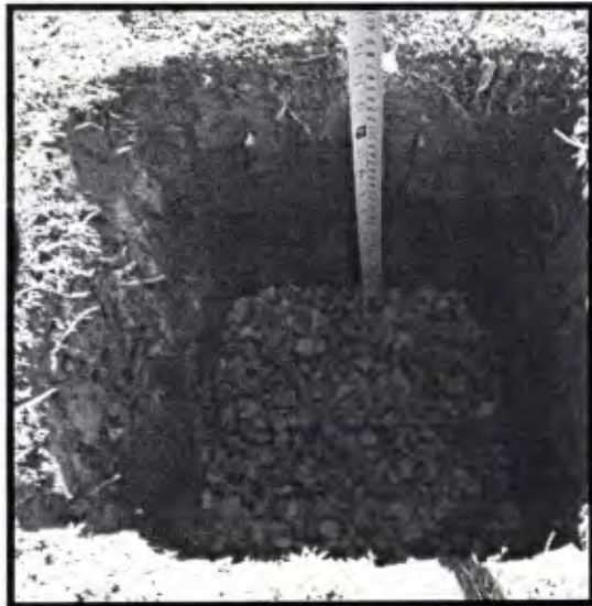
IMAGEM 02 – Imagem da cova perfurada para o teste de percolação
