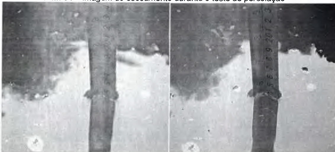
IMAGEM 04 – Imagem do escoamento durante o teste de percolação
