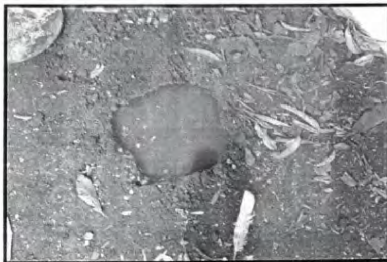
IMAGEM 03 – Imagem da cova cheia de água durante o teste de percolação
